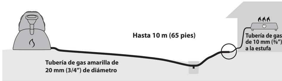
3. En la tubería de gas se acumula condensación del biogás. Es importante que la tubería de gas sea instalada en un ángulo ligero y continuo desde el sistema, para que el agua fluya hacia el punto más bajo.
