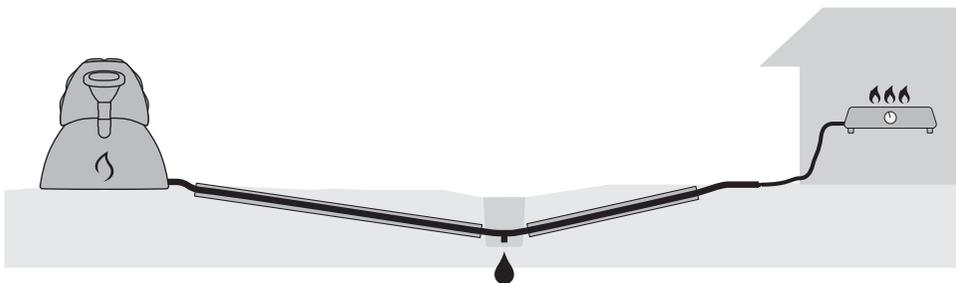
Pase la tubería de gas por un tubo rígido (PP/PVP de 40 mm [1¼"]) para protegerla.
