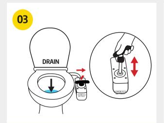
TURN THE SWITCH TO THE RIGHT (DRAIN MODE) AND PUMP SEVERAL TIMES
